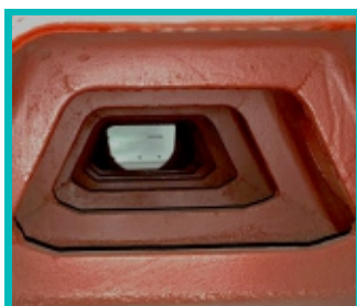
Vnitřní žebrování základny
